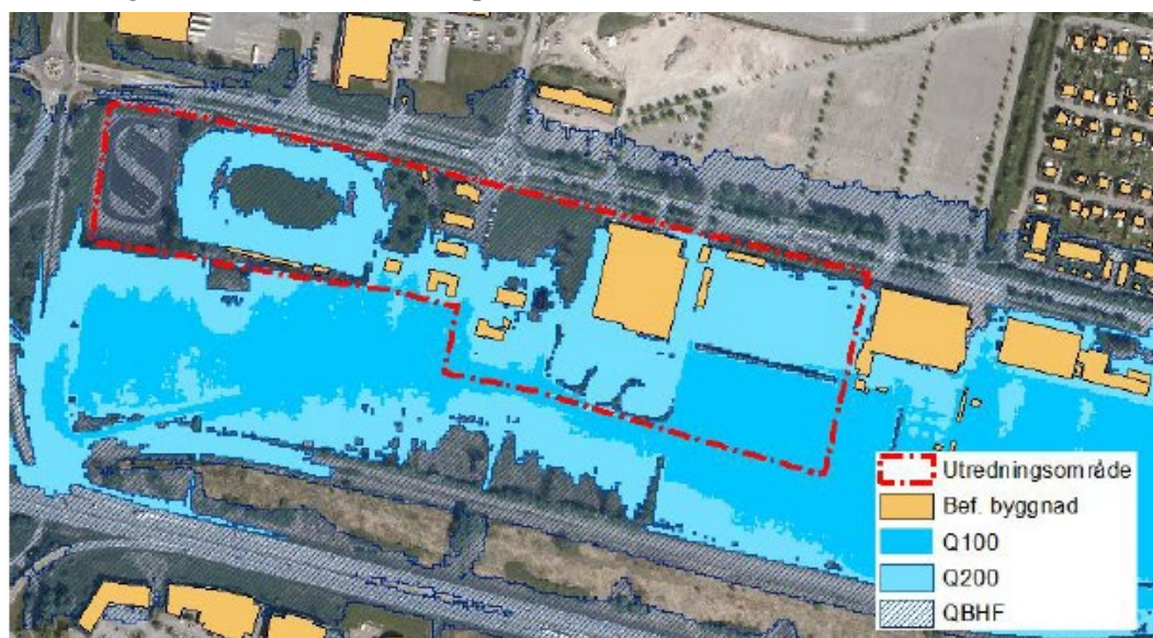
Figur 7. Modifierat utdrag ur MSB:s översvämningskartering över Mölndalsån som även täcker aktuellt utredningsområde. Utbredningen som visas motsvarar 100-, 200- och beräknat högsta flöde. Källa: MSB, 2013.
