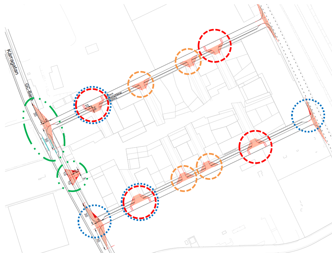
Figur 12 Förslag - Röd cirkel: Upphöjd korsning, korsning dimensionerad efter LBN. Orange cirkel: Korsning dimensionerad efter Lu. Blå cirkel: Planen bör ses över med hänsyn till sikt. Grön cirkel beskrivs närmare nedan
