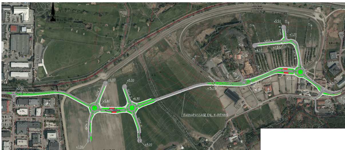
Figur 37. Föreslagen sträckning av nya Lunnagårdslänken samt lokalgator inkl höjdsättning. Källa: Markera, 2021-03-16
