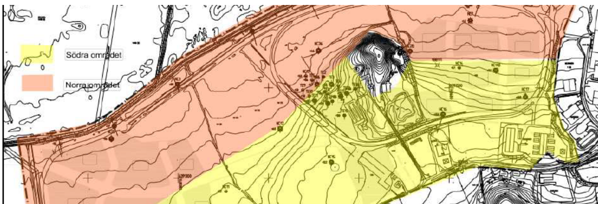
Figur 9 – Översikt över områdets uppdelning med avseende på lerans skjuvhållfasthet, det norra området i orange och det södra i gult. Källa: Norconsult, 2021-01-15
