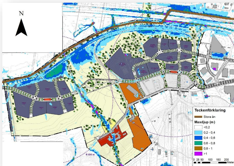
Figur 4. Beräknat vattendjup vid ett klimatanpassat 100-årsregn för scenario 2, för befintlig situation (Mannings tal = 18 ). Detta får anses beskriva ett normalfall för Stora åns avledningsförmåga med viss växtlighet i å-fåran, dvs. att Stora ån är relativt nyrensad.
